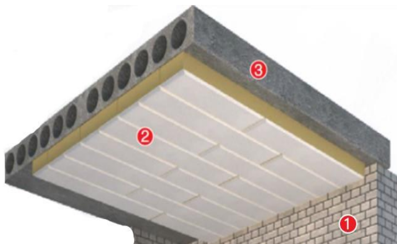
1 – стіна (або фундамент); 2 – утеплювач; 3 – плита перекриття
