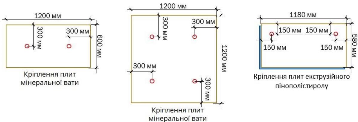
Рисунок 2. Схема кріплення теплоізоляційних плит з мінеральної вати і екструзійного пінополістиролу
