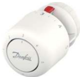
Рис.14. Термостатичний елемент типу Aero RA MIN 16° з конструктивним обмеженням мінімальної нижньої межі регулювання температури повітря (діапазон налагоджування 16...28 °С)
